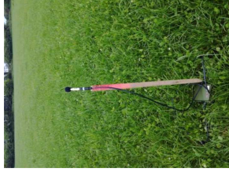
Photo 1 : Pose d'enregistreur d'ultrasons de type SM4bat
