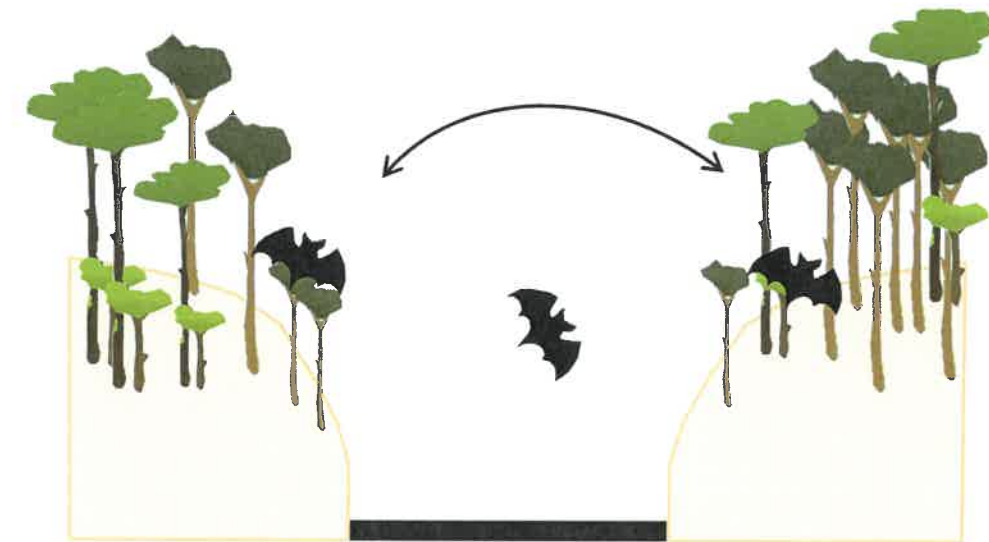
Figure 7 - Schéma de principe du passage des chiroptères en secteur de déblai.
